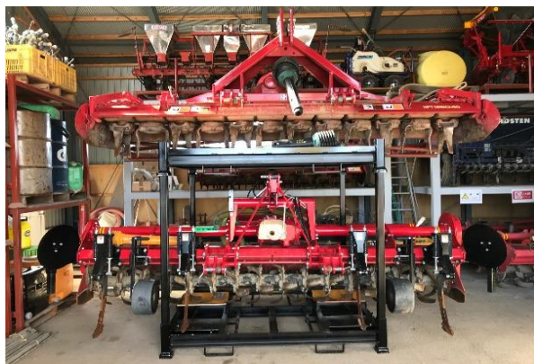
★使用例★ 2段積み合わせ ロータリー3.3m + パワーハロー3.5m
